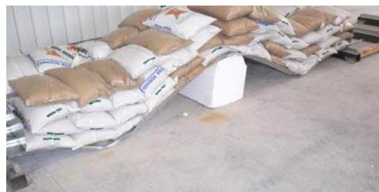
Imagen 2 y 3. Ensayo de carga de los perfiles INCO 44.4 Curvado y INCO 44.6 Ondulado Curvado y colapso del arco para la determinación de la carga máxima admisible
