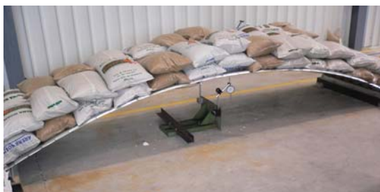
Imagen 2 y 3. Ensayo de carga de los perfiles INCO 44.4 Curvado y INCO 44.6 Ondulado Curvado y colapso del arco para la determinación de la carga máxima admisible
