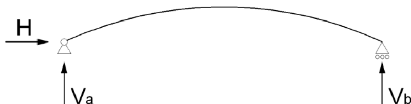
Gráfico 2. Modelización del arco con un apoyo que permite desplazamiento horizontal
