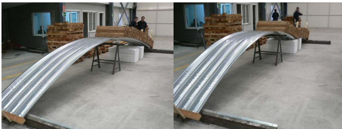
Imagen 9 y 10. Carga Asimétrica Distribuida sobre la mitad de la pieza.
