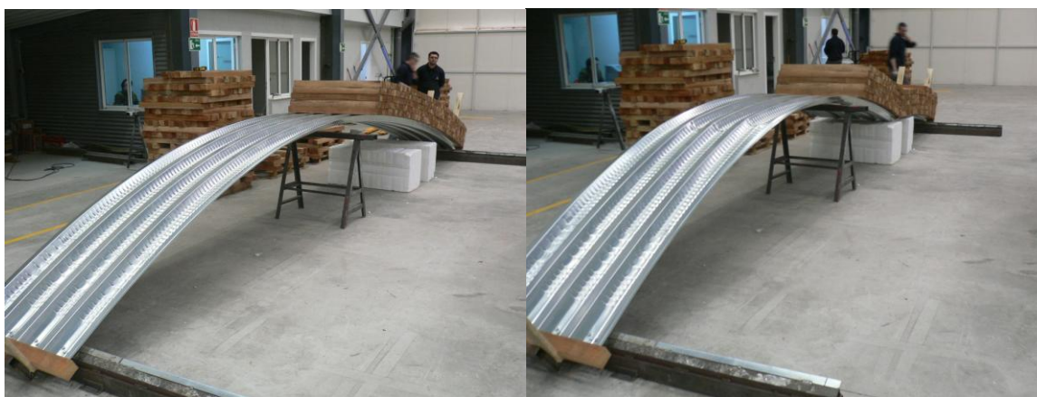
Image 9 et 10. Charge Asymétrique sur la moitié de la pièce.
