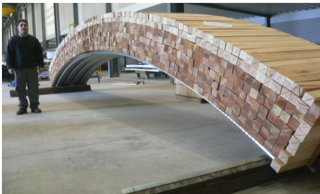
Image 7. Essais de charge des profils INCO 70.4 pour différentes portées et épaisseurs
