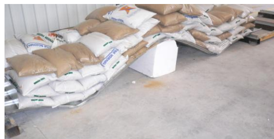
Image 2 et 3. Essai de charge des profils INCO 44.4 et INCO 44.6 Ondulé Courbé et effondrement de l'arc pour la détermination de la charge maximale admise
